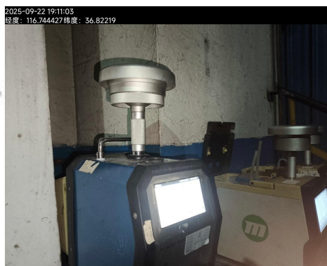
附图 5：五号六号炉顶装煤塔 无组织废气采样
